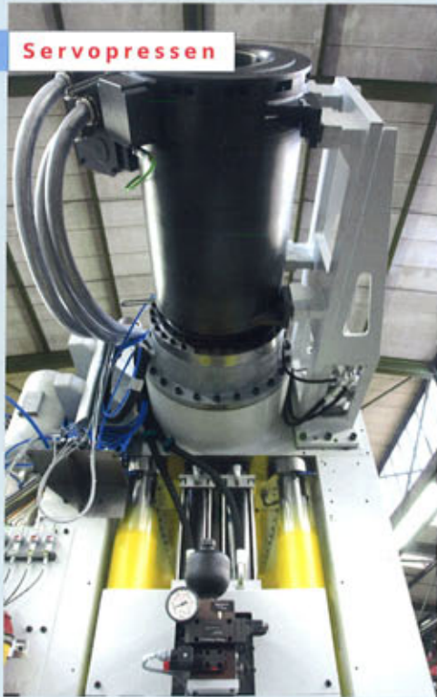
Präzise Antriebsregelung gewährleistet der Torquemotor 1FW3
