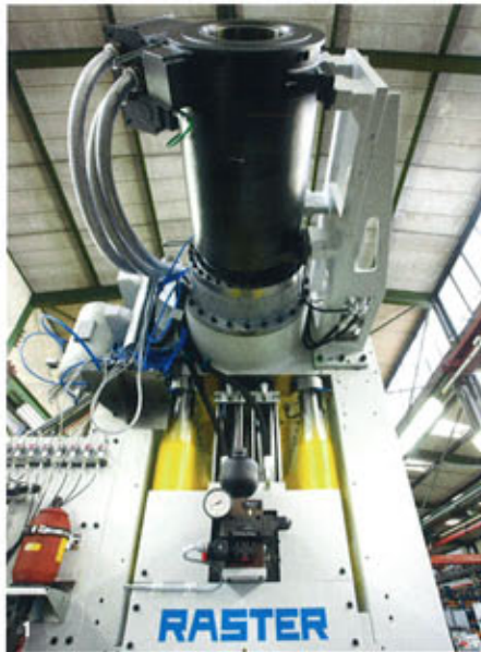
1-3 _ Ein Blick unter die Haube von Raster Technologys neuem 200-Tonnen-Servomotion (Bilder: Raster Technology)
